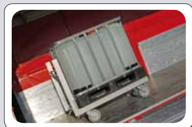
Rollcontainer Bremstest: ungesicherter Rollcontainer - Gesamtgewicht 1000 Kg und 17% Gefälle
