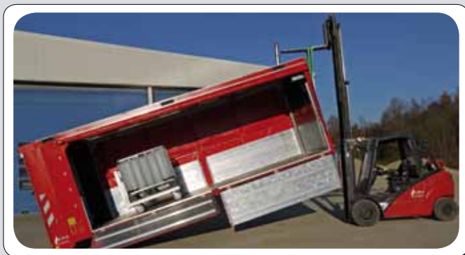
Rollcontainer Bremstest: ungesicherter Rollcontainer - Gesamtgewicht 1000 Kg und 17% Gefälle
