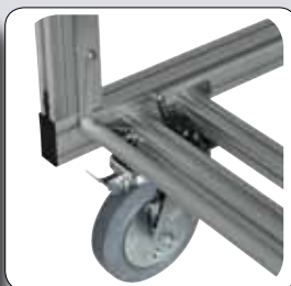
Rollcontainer Bremstest: ungesicherter Rollcontainer - Gesamtgewicht 1000 Kg und 17% Gefälle
